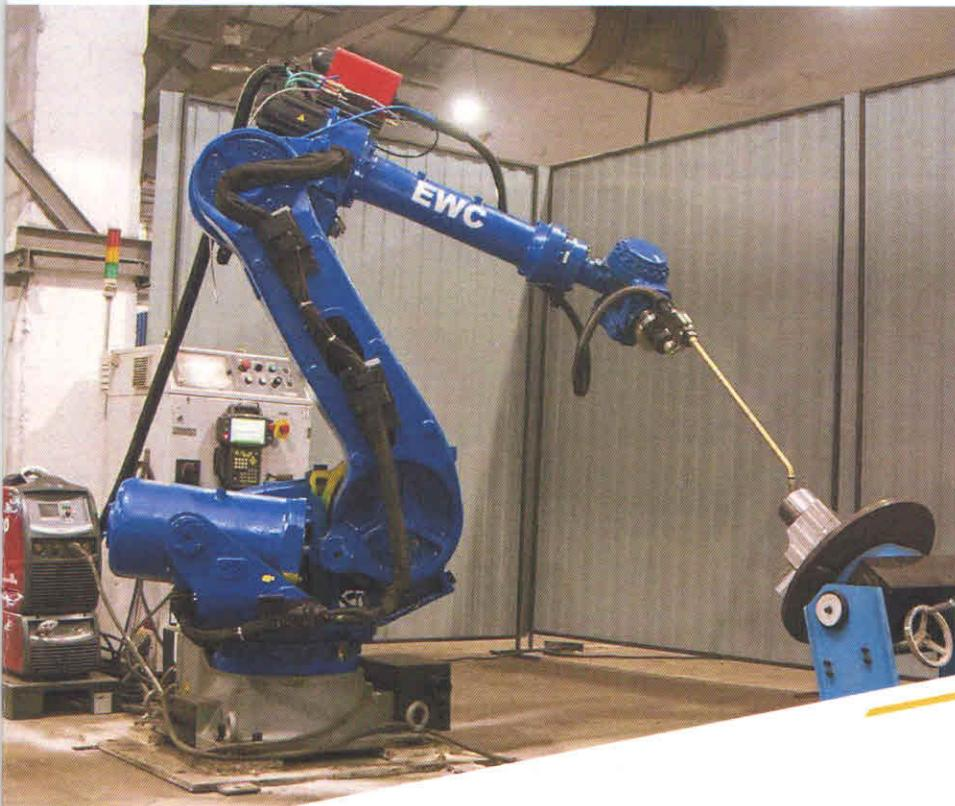
Для нанесения наплавочного слоя на заводе используется различное импортное оборудование.
